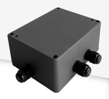
Controladores ArtNet/sACN a SPI para píxel mapeado en instalaciones de tiras de LED en interiores y exteriores. Dos puertos Ethernet y un conmutador integrado proporcionan capacidad de conexión en cascada. Convierte directamente hasta 16 universos DMX en SPI para controlar 2,730 RGB pixeles soportando 8 salidas LED separadas.
