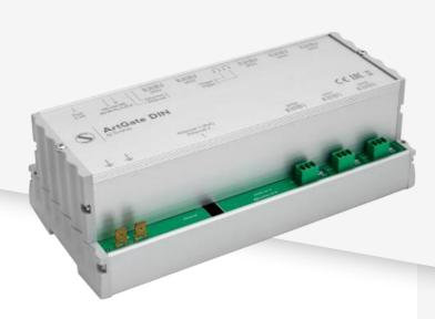
Convertidor multifuncional en montaje DIN que interpreta los protocolos Ethernet (ArtNet, sACN) a DMX para controlar más instalaciones de luces a través de la red Ethernet LAN en modo 10/100 Base-T.
