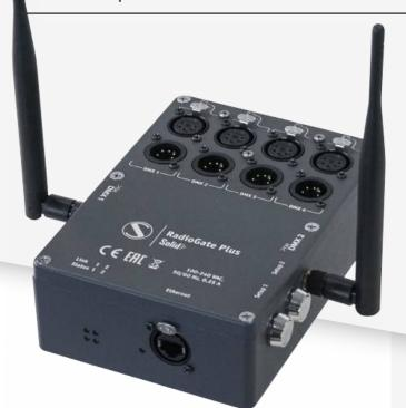
Conversor híbrido DMX ArtNet/sACN usando la red Ethernet LAN en modo 10/100 Base-T para transmitir la señal DMX y proveer excelente respaldo a través de los canales inalámbricos 2.4 GHz. Opción inteligente para ir de gira como un dispositivo de repuesto que cubre ambas tecnologías de transmisión. Embalado en cajas de metal fundido a presión, totalmente protegido de la niebla y el humo, con aislamiento galvánico en todos los puertos.
