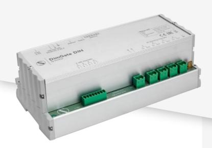
DimGate DIN es un regulador híbrido en carril DIN que convierte señal DMX512 en 4 salidas independientes 110-230 VAC de hasta 1.2 kW cada una para gestionar la regulación de lámparas incandescentes. Se suministran 4 salidas adicionales de 1-10V (o 0-10V) para integrar dispositivos con controladores de atenuación de 1-10V y balastos electrónicos en entornos controlados por DMX.
