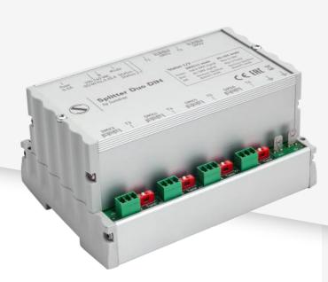
Splitter DIN DUO es un dispositivo especial en montaje carril DIN con 6 puertos de entrada/salida DMX que opera como un splitter normal con 1 entrada y 5 salidas, o también funciona como dos splitters separados. Todos los canales de entrada y salida disponen de aislamiento galvánico. Compatible con Gestión Remota de Dispositivos (RDM). El dispositivo es apto para uso interior. Los splitters están alimentados por una red industrial AC de 100-250V y consumen menos de 5 vatios
